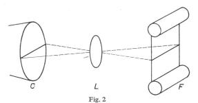
Die Radarsignale werden auf einem Kathodenstrahlrohr sichtbar gemacht und kinematographisch aufgenommen
