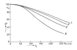
Fig. 4 **Räumliche Frequenzgänge der wichtigsten Elemente**  $f_p$  prozentualer Frequenzgang;  $f_r$  räumliche Frequenz; L Linse; C Kathodenstrahlrohr; A kombinierter Frequenzgang; F Film
