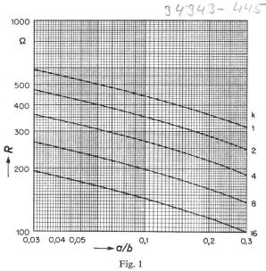
Wellenwiderstand R eines schmalen Leiterpaares a/b Verhältnis von Leiterbreite zu Leiterabstand k Dielektrizitätskonstante
