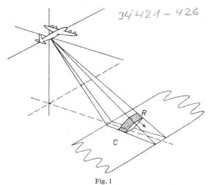
Das Prinzip des seitlich ausleuchtenden Radars R Radarimpuls; C abgetasteter Bodenstreifen
