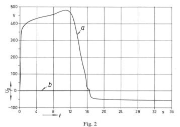
Verlauf der Gitter-Kathodenspannung  $U_g$  in stabilisierten Netzgeräten während der Anheizzeit bei Verwendung eines Trockengleichrichters  $(U_1 = 470 \text{ V})$
