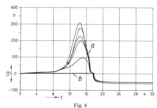
Wie Fig. 2, aber bei Verwendung von fünf verschiedenen Gleichrichterröhren  $(U_1 = 510 \text{ V})$ Bezeichnungen siehe Fig. 2
