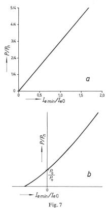
Minimaler relativer Erregerstrom eines Turbogenerators (a) bzw. einer Schenkelpolmaschine (b) in Funktion der relativen Wirkleistung P Wirkleistung;  $P_n$  Nennwirkleistung;  $P_0$  Wirkleistung bei Erregerstrom null;  $I_{e\ min}$  minimal zulässiger Erregerstrom;  $I_{e0}$  Leerlauferregerstrom
