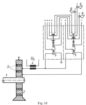
Überwachung der Lagerisolation von Generatoren
