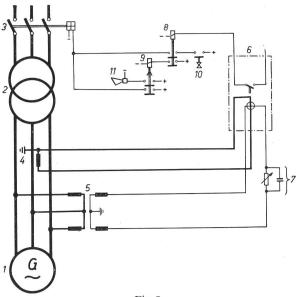
Fig. 9 Zweistufiger Rückwattschutz
