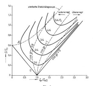
Fig. 6 V-Kurven der Synchronmaschine
