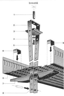
Nouveau dispositif mobile et central pour suspension aux pla-fonds. Plus d'enfilage. Les câbles s'introduisent tout tendus, sans être gênés par des suspensions latérales. Temps de posage abrégé et montage facile, également par personnel non spécia-lisé. Pas besoin d'outils spéciaux.
