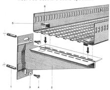
Les dispositifs de fixation sont normalisés pour le montage au plafond et à la paroi. Les chemins de câbles HEER sont livrables en 5 largeurs: 140, 210, 280, 350 et 420 mm, avec tous accessoires, soit: coudes horizontaux et verticaux, pièces T et + avec réductions et embranchements de 0 à 90°, équerres et pièces d'acces préferences et extérieures et avtérieures et avtérieures et pièces
