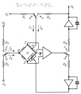
Fig. 1 Prinzipschema der Multiplikations- und Divisionsschaltung  $U_0$  Ausgangsspannung
