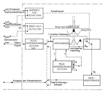
Fig. 2 Blockschema des Drop-Out-Kompensators Erklärungen siehe im Text
