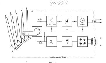
Fig. 1 Prinzipschema der rotierenden Baugruppe A.C. Signalspannung; D.C. Gleichstrom Bauteile in der oberen Reihe: Verstärker, Modulator, Sender;
