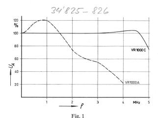
Verbesserung der Frequenzkurve des Fernsehkanals U<sub>A</sub> Ausgangsspannung; f Frequenz; VR 1000 A älteres Maschinenmodell; VR 1000 C neueres Maschinenmodell
