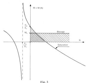
Zone-solution finale pour les valeurs du fan-in M et du fan-out N  $C_n$ ,  $D_n$ ,  $E_n$ ,  $M_o$  valeurs caractéristiques de l'équation (3)
