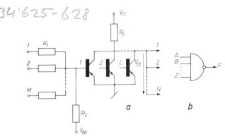
Fig. 1 Porte du type «NOR» dans la logique RTL a Schéma électrique; b Schéma logique.  $F = \overline{A + B + ... + Z} = \overline{A} \cdot \overline{B} \cdot ... \cdot \overline{Z}$
