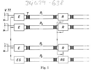
Schéma de l'ensemble d'un système de transmission PCM par câbles téléphoniques
