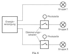
Blockschema einer Tunnelbeleuchtungsanlage
