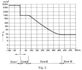
Empfehlenswertes Beispiel einer Leuchtdichtekurve (für eine Fahrgeschwindigkeit von 75 km/h) [1]
