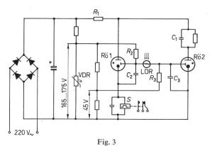
Schaltschema eines elektronischen Dämmerungsschalters VDR spannungsabhängiger Widerstand; LDR Photozelle; S Schaltkontakt;  $R\ddot{o}$  1,  $R\ddot{o}$  2 Kaltkathoden-Relaisröhre;  $R_1...R_3$  Widerstand;  $C_1...C_3$  Kondensator
