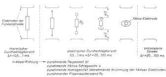
Fig. 15 Modell einer stoßstrom-ionisierten Funkenstrecke
