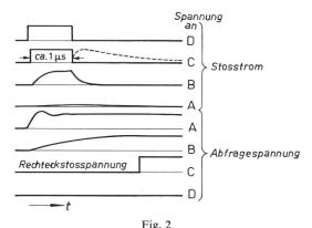
Spannungsverlauf an verschiedenen Punkten A, B, C, D des Stossgenerator in Fig. 1
