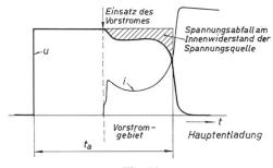
Fig. 16 Vorentladungen während des Ansprechverzuges u Spannung: i Strom: t Zeit; ta Ansprechverzug;
