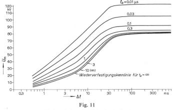
Wiederverfestigungskennlinien Kugel—Kugel Durchmesser  $d=10~{\rm cm}$ ; Schlagweite  $a=3~{\rm cm}$
