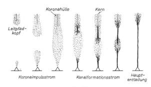
Fig. 26 Endüberschlag zwischen Blitzkopf und Erde
