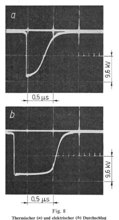
Prüfling: Stab—Stab, Schlagweite a = 7 cm, Pausenzeit  $\Delta t = 0.59$  ms
