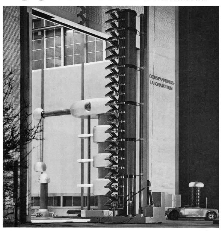
Freiluft-Prüfplatz vor dem neuen Hochspannungs-Laboratorium der Micafil AG in Zürich Micafil-Pressgas-Kondensator 750 kV Wechselspannungs-Prüfkaskade, 1350 kV Prüfspannung, Fabrikat Sécheron
