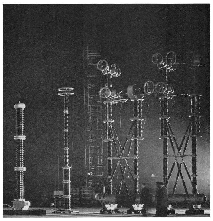
Kapazitiver Spannungswandler Micafil BBC-Hochspannungsstützer 750 kV
