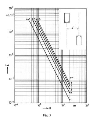
Minimale Hintergrundsleuchtdichte  $\overline{L}$  in Abhängigkeit vom seitlichen Abstand d der entgegenkommenden Fahrzeuge bei einem Schwellenwert des
