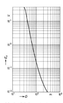
Fig. 7 Vertikale Beleuchtungsstärke  $E_v$  auf der Strasse, herrührend von Abblendlichtern in Abhängigkeit von der Entfernung D vom Fahrzeug
