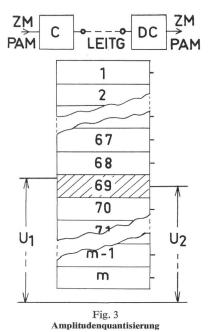
$U_1$  Eingangsimpuls;  $U_2$  Ausgangsimpuls; C Coder; DC Decoder
