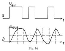
Verzerrung eines Codewortes wie bei Fig. 15 a Eingangssignal; b Ausgangssignal
