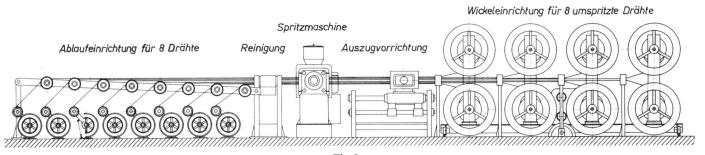
$Fig. \ 9 \\$  Spritzgussanlage für 8 Klein-Koaxialpaare
