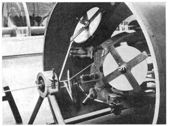
Fig. 14 Zweiter Eisenbandspinner mit Papierwickler
