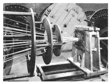
Fig. 19 Verseilung eines Kabels mit 12 Klein-Koaxialpaaren
