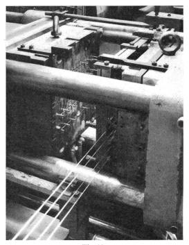
Fig. 10 Spritzgussform für 8 Klein-Koaxialpaare
