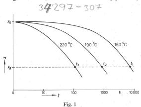
Schema einer Alterungsprüfung x untersuchte Eigenschaft;  $x_0$  Eigenschaft vor der Alterung;  $x_g$  als Prüfkriterium festgelegter Grenzwert; t Alterungsdauer;  $t_1$ ,  $t_2$ ,  $t_3$  Zeitwerte bis zum Erreichen des Eigenschaftsgrenzwertes für 3 Prüftemperaturen
