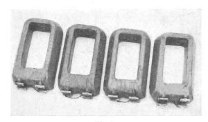
Fig. 9 **Hauptpolspulen für Alterungsversuche**aus zwei parallelen Leitern gewickelt
