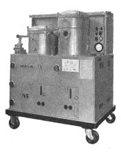
**Anlagen** für die **Aufbereitung** und Regenerierung von **Transformatorenöl**
