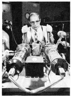
Hochvacuum-Forschung führte zu einem völlig neuartigen Leistungsschalter G-E Vacuumunterbrecher.
