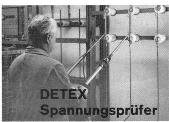
DETEX-Hochspannungsprüfer für die Feststellung von Spannungsfreiheit in Hochspannungsschaltanlagen und Trafostationen.
