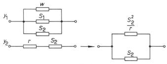
Fig. 5 **Brückenzweige aus der Schaltung Fig. 4A**r Kompensationswiderstand
