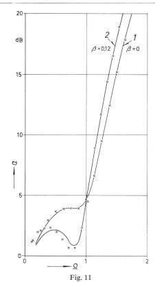
Betriebsdämpfung ohne Kompensation (1) und mit Kompensation durch zwei Röhren (2), mit Messpunkten
