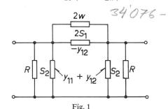
II-Glied mit längsliegenden Verlusten (2w) w Längsverluste (parallelliegend);  $S_1$ ,  $S_2$  Blindwiderstände;
