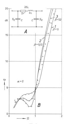
$\label{eq:Fig.9} \textbf{$\Pi$-Glied mit Reihenverlust der Induktivität}$
