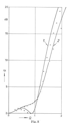
Berechnete Betriebsdämpfung ohne Verluste (1) und Messpunkte der Verlustkompensation mit zwei Röhren
