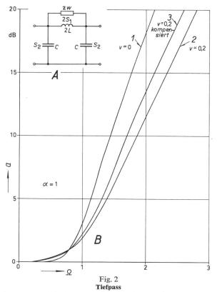
A mit Verlusten behaftet; B Betriebsdämpfung a ohne (1) und mit (2) Längsverlusten, sowie mit Kompensierung des sich den Abschlusswiderständen parallel legenden Verlustanteils (3) mit  $\alpha = 1$  $\Omega$  normierte Frequenz;  $\alpha$  normierter Abschlusswiderstand;
