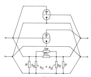
Fig. 7  $\Pi$ -Glied mit längsliegenden Verlusten und mit zwei entgegengesetzt parallel liegenden Röhren
