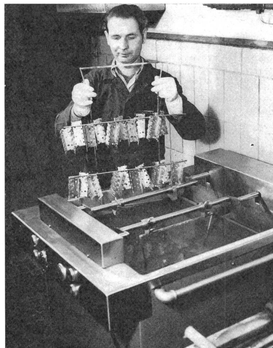
Fig. 6 Praktischer Einsatz einer Platten-Schwingwanne mit Bewegungs- vorrichtung
