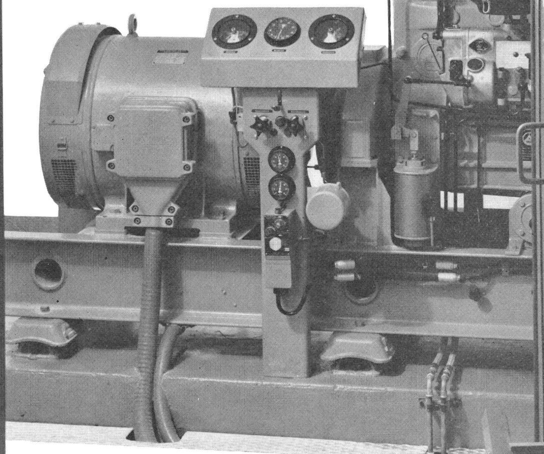
Betriebssichere, kompakte Bauart, ohne Kollektor.
