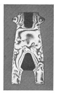
Examen en photoélasticité plane des tensions internes. Isolateur 24 kV 1250 kg.
