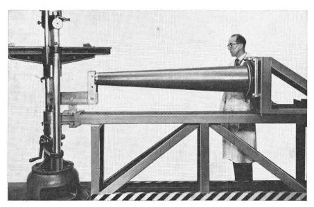
Essai à la flexion d'un isolateur de 170 kV.
