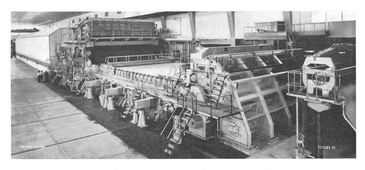
Zeitungspapiermaschine mit einer Siebbreite von 8300 mm (max. Arbeitsgeschwindigkeit 900 m/min) in der Papierfabrik A. Ahlström Oy, Warkaus, Finnland
