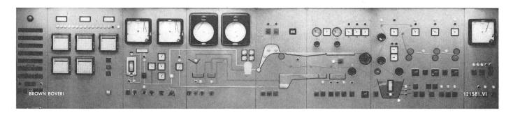
Diese Bedienungstafel enthält die Geräte und Apparate für die Überwachung, Steuerung und Regelung der Nasspartie oben abgebildeter Papiermaschine
