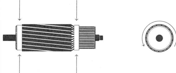
Aus Versehen lief dieser Rotor mit der dreifachen Tourenzahl. Dank einer Res-i-Glas®-Wicklungsbandage blieb der Stator unbeschädigt. Rotorbandagen aus Res-i-Glas besitzen die grösste Zugfestigkeit bei gleichem Querschnitt als Stahldrahtbandagen, sind billiger und sehr einfach zu verarbeiten. Ausserdem bilden Res-i-Glas-Bandagen keine Wirbelströme wie dies bei Verwendung von Stahldrahtbandagen der Fall ist.
