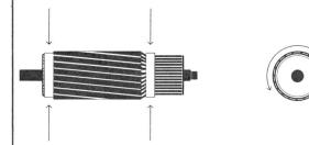
Aus Versehen lief dieser Rotor mit der dreifachen Tourenzahl. Dank einer Res-i-Glas®-Wicklungsbandage blieb der Stator unbeschädigt. Rotorbandagen aus Res-i-Glas besitzen die grössere Zugfestigkeit bei gleichem Querschnitt als Stahldrahtbandagen, sind billiger und sehr einfach zu verarbeiten. Ausserdem bilden Res-i-Glas-Bandagen keine Wirbelströme wie dies bei Verwendung von Stahldrahtbandagen der Fall ist.
