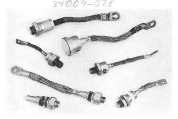
Fig. 1 Silizium-Leistungsdioden verschiedener Fabrikate Nennstrom pro Diode ca. 200 A
