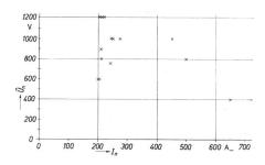
Fig. 2 Nenndaten verschiedener Silizium-Leistungsdioden Periodisch zulässige Spitzensperrspannung  $\hat{U}_n$  als Funktion der Nennstromstärke  $I_n$  (Mittelwert über eine volle Periode bei sinusförmigem Stromverlauf)
