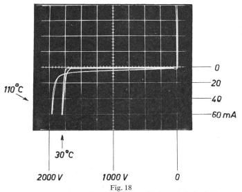
Sperrkennlinie einer stoßspannungsfesten 200-A-Si-Diode im kalten und betriebswarmen Zustand
