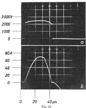
Belastung einer stoßspannungsfesten Si-Leistungsdiode DS 200 in Sperrichtung
