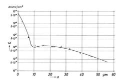
Fig. 10 Konzentrationsprofil einer speziellen Diffusion von Gallium in Silizium Konzentration der eindiffundierten Ga-Atome C als Funktion der Entfernung von der Oberfläche x
