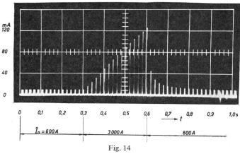
Oszillogramm der Sperrströme einer Si-Leistungsdiode DS 200 bei Nennstrom und bei 5facher Überlast Prüfschaltung nach Fig. 15
