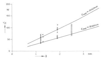
Fig. 33 Stossdurchschlagspannung  $\hat{v}$  in Funktion der Isolationsdicke  $\delta$  einer normalen PVC-Kabelmischung Stosswelle  $1|50~{\rm LIS}$
