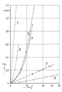
Fig. 28 Längsspannung  $\hat{U}$  des Spezialkabels I, Aufbau nach Fig. 17 (siehe auch Tabelle I, Nr. 2) 1 Gleichstrom; 2 und 3 Stoss 8 | 18  $\mu$ s; 4 Stoss 98 | 220  $\mu$ s; 5 Stoss 95 | 215  $\mu$ s; 6 Stoss 260 | 580  $\mu$ s
