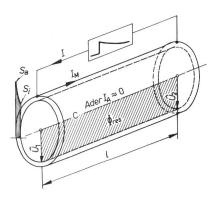
Fig. 4 Verlauf der Stromdichte im Kabelmantel bei Stoss I Blitzstrom (Meßstrom);  $I_A$  Kabeladerstrom;  $I_M$  Kabelmantelstrom;  $\mathcal{O} = I_M R_K$  Längsspannung;  $\mathcal{O}_1$ ,  $\mathcal{O}_2$  Aderspannung 1 bzw. 2;  $S_a$  Stromdichte aussen;  $S_4$  Stromdichte innen; C Kabelachse; I Länge der Messstrecke;  $\Phi_{res}$  magnetischer Fluss im Kabelinnern
