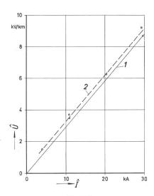
Fig. 26 Längsspannung  $\dot{v}$  eines nicht armierten Bleimantelkabels in einem durchverbundenen Zoreskanal Nr. 4, von dem jedoch nur die untere Hälfte verlegt wurde
