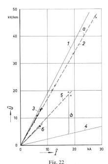
Längsspannung  $\hat{U}$  eines nicht armierten Bleimantelkabels, Aufbau nach Fig. 6
