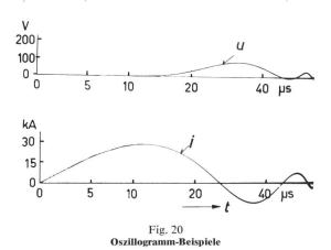
(Kabeltyp FF) u Längsspannung; i Mantelstrom; t Zeit
