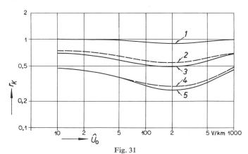
Reduktionsfaktor  $r_K$  in Funktion der induzierten Spannung  $\hat{U}_0$  pro km bei 50 Hz für übliche Papierbleikabel
