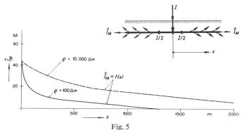
Verlauf des Kabelmantelstromes entlang dem Kabeltrassé bei einem Blitzeinschlag an der Stelle x=0
