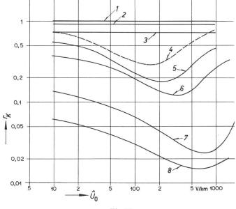
Fig. 30 Reduktionsfaktor  $r_K$  in Funktion der induzierten Spannung  $\hat{\mathcal{U}}_0$  pro km bei 50 Hz
