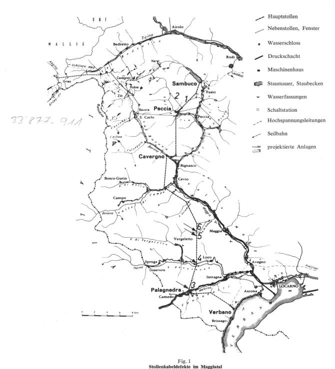
Kunststoffkabel: 1 Peccia-Sambuco; 2 Peccia-Erta Papierbleikabel: 3 Kabelfehler 540 m ab E. V. Palagnedra; 4 Kabelfehler Stollenfenster Isorno; 5 Kabelfehler bei km 7,956; 6 Kabelfehler bei km 8,063
