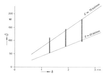
Fig. 34 Stossdurchschlagspannung  $\hat{\mathcal{U}}$  in Funktion der Isolationsdicke  $\delta$  eines gebräuchlichen Polyäthylenmantels Stosswelle 1 | 50  $_{\rm HS}$
