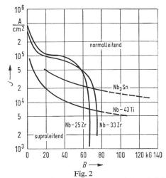
Abhängigkeit der Stromdichte j von der magnetischen Induktion B als kritische Grenzkurve einiger harter Supraleiter
