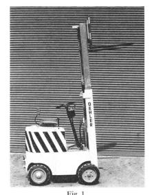
Sitzgabelstapler Oehler, Typ 1063, für 1000 kg Tragkraft
