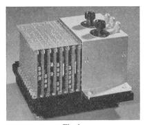
${\rm Fig.} \ 1$  Funktionsblock für die kontaktlose Steuerung von Transportanlagen
