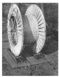
Fig. 2 Abrollgerät und Kabeltrommel
