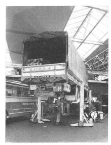
Fig. 2 Schlieren-Hebeböcke
