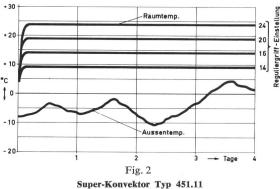
Abhilfe wurde der *Super-Konvektor* mit Luftbefeuchtung geschaffen, der mit einer Leistung von 1800 W erhältlich ist und zur individuellen Anpassung der Raumtemperatur einen einstellbaren Regler aufweist. Der in Fig. 2b registrierte Raumtemperatur-Verlauf bezieht sich auf einen Raum von 50 m³ Inhalt und 2 Aussenwänden. Die Regeldifferenz im Raum beträgt ca. 1 °C.
