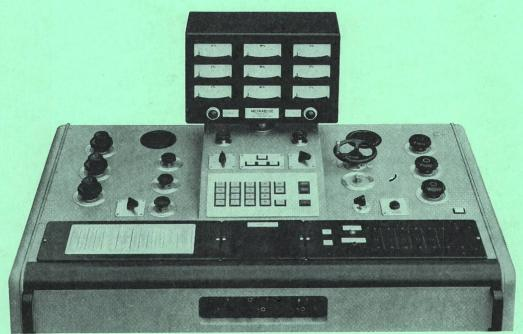
Die neue Eichstation mit Präzisions-Eichzählern und elektronischer Impulssteuerung ermöglicht die halbautomatische Abwicklung von Messvorgängen zur wirtschaftlichen Prüfung kleinerer und grösserer Serien von Einphasen- und Drehstromzählern. Der Dreisystem-Gleichlast-Impuls-Eichzähler steuert die zu prüfende Zählerserie direkt mittels eines elektronischen Dekadenzählwerks mit Impulsvorwahl, das für die Anpassung an die Zählerkonstanten bestimmt ist. Wesentliche Vorteile:
