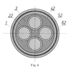
TT-CT 4×95 rCu 3PE Thermoplastisoliertes Kabel, Eisenband armiert mit äusserem Thermoplast-Schutzmantel
