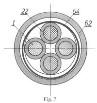
$\begin{array}{ccc} \text{TCu-T} & 4{\times}50 \text{ rCu } 3\text{PN} \\ \text{Kabel mit thermoplastisolierten Adern,} \\ \text{Kupfermantel, und Thermoplast-Schutzh\"{u}lle} \end{array}$
