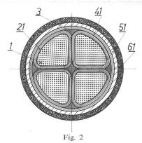
PPb-J  $4\times120$  sAl 3PE Papierbleikabel mit imprägnierter Jutebewicklung. Leiter: Aluminiumseil sektorförmig
