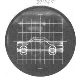
hervorgerufenen Reaktionen des Kraftwagens berechnet. Das stilisierte Bild eines Autos auf dem Oszillographenschirm zeigt die Schwingung der Vorder- und Hinterachse und des Fahrzeugaufbaues, wie sie an einem wirklichen Fahrzeug ebenso beobachtet würden. Damit kann das Fahrverhalten eines Kraftwagens und somit seine Güte schon im Reissbrettstadium untersucht werden.
