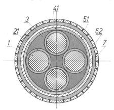
Fig. 5 PPb-TF 4×120 rCu 3PN Papierkabel mit Thermoplasthülle, Flachdraht armiert
