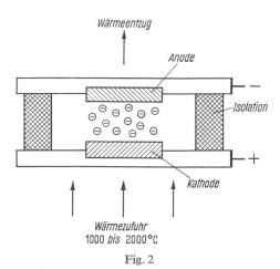
Aufbau eines thermoionischen Konverters
