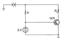
Fig. 3 Einfache Verzögerungsschaltung mit der elektrolytischen Zelle
