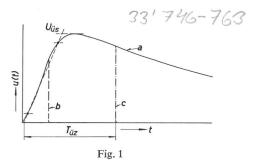
Zur Definition der Stoßspannungen
