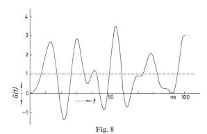
Übergangsfunktion eines rein kapazitiven Spannungsteilers G(t) Übergangsfunktion; t Zeit C=150 pF;  $C_e=40$  pF;  $C_p=1$  pF; L=2.5  $\mu$ H; R=20  $\Omega$  Bedeutung dieser Grössen siehe Fig. 9
