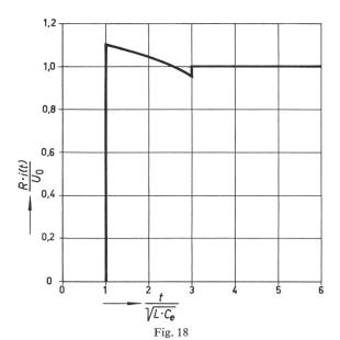
Stromverlauf am Ende einer widerstandsbehafteten kurzgeschlossenen Leitung:
