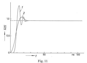
Übergangsfunktion gedämpfter kapazitiver Teiler: Einfluss von  $C_p$ Kurve  $I: C_p = 0.1 \text{ pF}; \text{ Kurve } 2: C_p = 1 \text{ pF}$   $C = 150 \text{ pF}; R = 1000 \Omega; L = 2.5 \mu\text{H}; C_o = 40 \text{ pF}$ Weitere Bezeichnungen siehe Fig. 8
