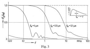
Amplitudenspektren voller und abgeschnittener VDE-Stoßspannungen  $1 \mid 50$   $F_0(\omega)$  Bezogenes Amplitudenspektrum des Spannungsimpulses u(t); f Frequenz;  $t_a$  Abschneidezeit
