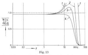
Amplitudengang gedämpfter kapazitiver Teiler: Einfluss von R bei erhöhter Induktivität L
