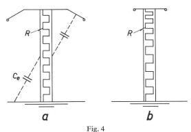
Steuerung Ohmscher Spannungsteiler durch Schirmelektroden (a) und nichtlineare Widerstandsverteilung (b)
