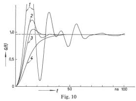
Übergangsfunktion gedämpfter kapazitiver Teiler: Einfluss von RKurven:  $I R = 250 \Omega$ ;  $2 R = 750 \Omega$ ;  $3 R = 1000 \Omega$ ;  $4 R = 2000 \Omega$  $C = 150 \text{ pF}; L = 2.5 \text{ } \mu\text{H}; C_e = 40 \text{ pF}; C_p = 1 \text{ pF}$ Weitere Bezeichnungen siehe Fig. 8
