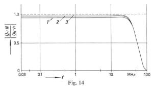
Amplitudengang gedämpfter kapazitiver Teiler: Einfluss von C Kurven: I C = 100 pF; 2 C = 200 pF; 3 C = 400 pF R = 1000  $\Omega$ ; L = 2,5  $\mu$ F;  $C_e$  = 40 pF;  $C_p$  = 1 pF Weitere Bezeichnungen siehe Fig. 9
