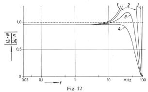
Amplitudengang gedämpfter kapazitiver Teiler: Einfluss von R Kurven:  $I~R=250~\Omega$ ;  $2~R=500~\Omega$ ;  $3~R=750~\Omega$ ;  $4~R=1000~\Omega$   $C=150~\mathrm{pF}$ ;  $L=2.5~\mu\mathrm{H}$ ;  $C_o=40~\mathrm{pF}$ ;  $C_p=1~\mathrm{pF}$  f Frequenz
