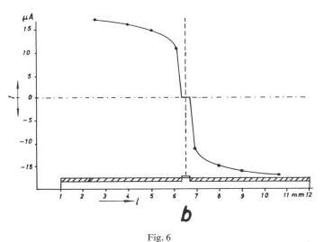
Charakteristik des Elementes mit schmaler Mittelschicht a der Lichtpunkt ist so breit wie die Mittelschicht b der Lichtpunkt ist kleiner als die Mittelschicht
