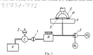
Schema der Prüfeinrichtung für die Untersuchung der Berstfestigkeit dünner Papiere
