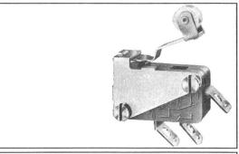
Mit der neuesten Entwicklung unseres Mikroschalter-Programms, dem Miltac XF, können wir Ihnen ein Schaltelement anbieten, das durch seine kleinen Abmessungen, seine hohe Schaltleistung und durch seine vielseitigen Betätigungsvorrichtungen einen besonders weiten Anwendungsbereich erschliesst. Abmessungen: 27,8 imes 15,9 imes 10,3 mm Isolierpresstoffgehäuse
