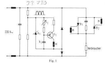
Vorschaltgerät zum Steuern von Wechselstromverbrauchern mit Thyristoren  $k_1$  Ladekondensator;  $n_1$  Zenerdiode; m Steuer-Induktivitäten;  $p_1$ ,  $p_2$  Thyristoren in Antiparallelschaltung;  $r_1$  Ladewiderstand;
