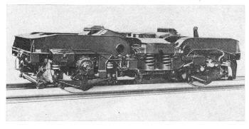
Fig.~1 Drehgestell der Schnellfahrversuchslokomotive E 10 299 der DB für 200 km/h
