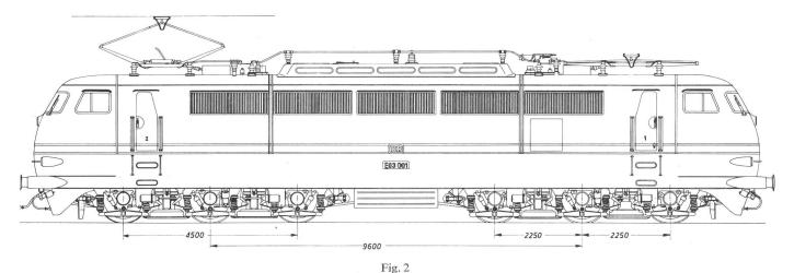
Seitenansicht eines Entwurfs der Schnellfahrlokomotive E 03 001 der DB für 200 km/h
