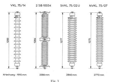
Vier mit der beschriebenen Methode untersuchte Langstabisolatorentypen
