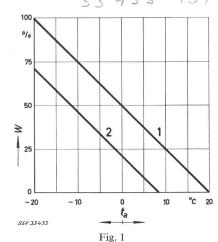
Heizenergiebedarf eines Wagens in Funktion der Aussentemperatur I bei unbesetztem Wagen; 2 bei besetztem Wagen und Sonneneinstrahlung
