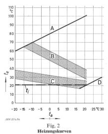
A Anheizen bei Nennspannung (1000 V); B starke Heizung; C schwache Heizung (Kaltblasschutz); D reine Lüftung;  $t_e$  Einblastemperatur der Luft;  $t_a$  Aussentemperatur;  $t_i$  Raumtemperatur
