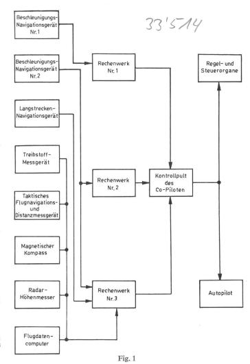
Elektronische Bordanlage für die Navigation eines Überschall-Verkehrsflugzeuges
