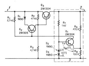
Fig. 1 Temperaturkompensierte, geregelte Spannungsquelle für 3 V 1 nichtstabilisierter Eingang; 2 stabilisierter Ausgang (3 V); 3 Spannungsvergleich mit Temperaturkompensation weitere Bezeichnungen siehe im Text
