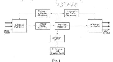
Blockschema einer digitalen Regeleinrichtung für Fabrikationsprozesse
