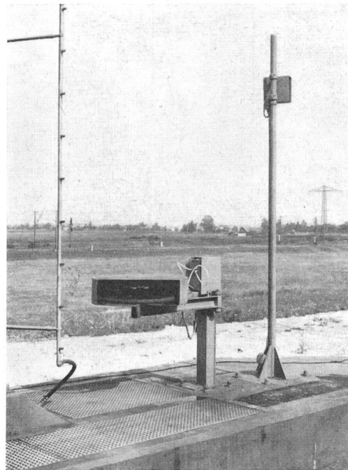
Fig. 2 Empfangsgerät der Lichtschranke mit Tastrad und Rohrständer des Benetzungsstandes
