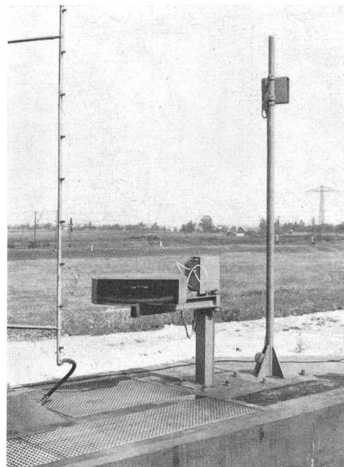
Fig. 2 Empfangsgerät der Lichtschranke mit Tastrad und Rohrständler des Benetzungsstandes
