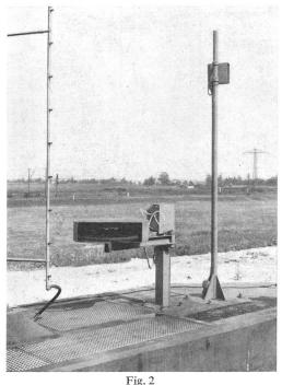
Empfangsgerät der Lichtschranke mit Tastrad und Rohrständer des Benetzungsstandes
