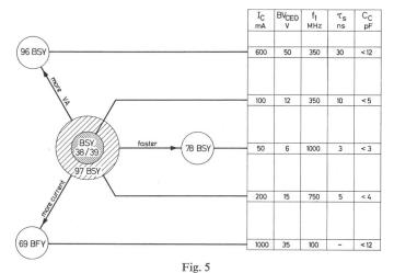
Wichtige elektrische Parameter einiger Schalttransistoren  $I_C$  Kollektorstrom;  $BV_{CEO}$  Kollektor-Emitter-Durchbruchsspannung;  $f_1$  Grenzfrequenz ( $\beta=1$ );  $\tau_s$  Speicherzeit;  $C_C$  Kollektorkapazität
