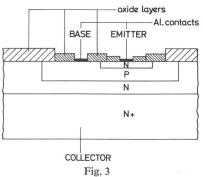
Schematischer Aufbau eines epitaxialen Planartransistors
