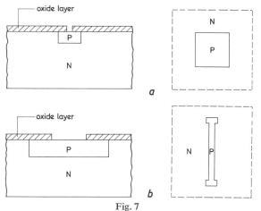
Konstruktion einer Diode (Kondensator) (a) und eines Widerstandes (b)
