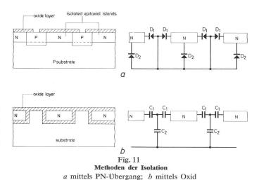
Eine weitere Möglichkeit der Isolierung ist ebenfalls in Fig. 11b und in Fig. 12 gezeigt. Hier sind N-leitende, monokristalline Inseln von SiO<sub>2</sub> umgeben und in polykristallines Silizium eingebettet.
