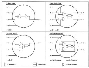
Fig. 20 Kombinationsschaltungen
