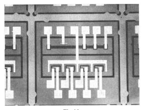
Fig. 16 Schaltung nach Anbringen der Leiterspuren
