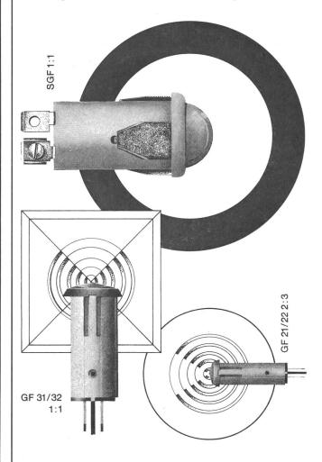
**Reihe SGF:** Die Lampe für Dauerbetrieb: über 50 000 Brennstunden. Sechs leuchtende Farben. Runde oder flache Front. Schwarze oder weisse Fassung. AMP-, Löt- oder Schraubanschluss. **Neu:** SGF 125 für 110–130 V (4 Farben, Lebensdauer 5000 h)
