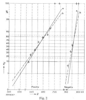
Überschlagspannung an einer Stab-Stab-Funkenstrecke von 120 cm bei einer Stosskurve von 500 | 2500 μs
