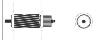
Aus Versehen lief dieser Rotor mit der dreifachen Tourenzahl. Dank einer Res-i-Glas®-Wicklungsbandage blieb der Stator unbeschädigt. Rotorbandagen aus Res-i-Glas besitzen die grössere Zugfestigkeit bei gleichem Querschnitt als Stahldrahtbandagen, sind billiger und sehr einfach zu verarbeiten. Ausserdem bilden Res-i-Glas-Bandagen keine Wirbelströme wie dies bei Verwendung von Stahldrahtbandagen der Fall ist.
