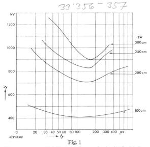
Überschlagspannung an Stab-Platte-Funkenstrecke in Abhängigkeit von der Frontzeit der angelegten Stoßspannung
