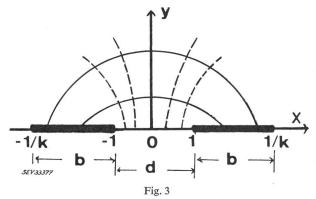
Querschnitt in der z = x + jy Ebene eines gedruckten Kondensators b Breite der Leiter, d Abstand zwischen zwei Leitern; k Modul des elliptischen Integrals erster Ordnung
