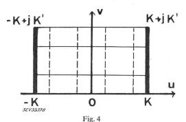
Abbildung der z-Ebene von Fig. 3 zur  $\underline{w} = u + \mathrm{j}v$ -Ebene Feldlinien Aequipotential-Linien K, K' Werte der elliptischen Integralen erster Ordnung Die Feld- und Aequipotential-Linien sind parallel zu den Achsen
