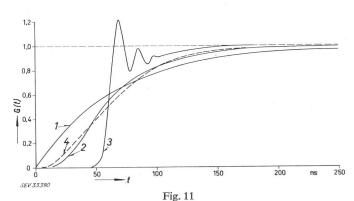
Vergleich der Ersatzschaltungen des Ohmschen Teilers bei  $R=10~\mathrm{k}\Omega$
