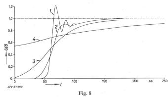
Wie Fig. 5, aber bei Änderung der Parallelkapazität  $C_p$  Konstanten:  $C_e=40$  pF, R=10 k $\Omega$ , L/R=10 ns I  $C_p=0$ ,01 pF; 2  $C_p=0$ ,1 pF; 3  $C_p=1$  pF; 4  $C_p=10$  pF
