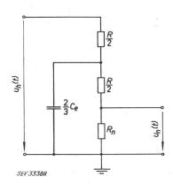
Fig. 9 Ersatzschaltbild des Ohmschen **Teilers**
