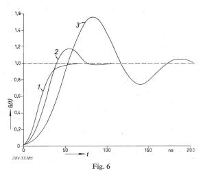
Wie Fig. 5, aber bei Änderung der Induktivität L Konstanten: R=3 k $\Omega$ ,  $C_e=40$  pF,  $C_p=1$  pF I L=10  $\mu$ H, (L/R=3,3 ns); 2 L=30  $\mu$ H, (L/R=10 ns); 3 L=90  $\mu$ H, (L/R=30 ns)
