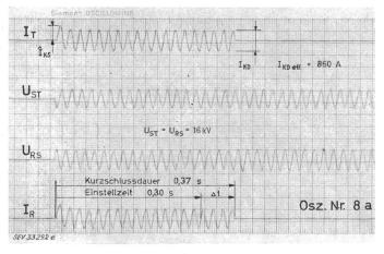
Fig. 6 Oszillogramm bei Einstellzeit 0,30 s
