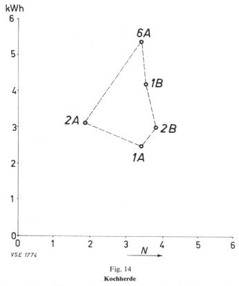
Korrelation zwischen der Anzahl Personen pro Haushalt (N) und dem mittleren täglichen Energieverbrauch (kWh). Untersuchung über die Mittelwerte der verschiedenen Abonnentengruppen
