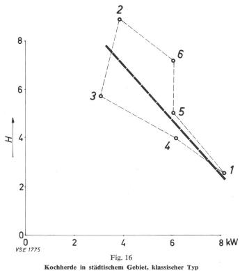
Kornelation zwischen der Gebrauchsdauer der Spitze (H) und der mittleren Leistung der Apparate (kW). (Die Ziffern der Fig. 16 entsprechen den Kurven der Fig. 15)
