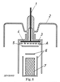
Bauweise eines Thyratrons mit Wasserstoff-Füllung [30]
