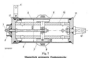
I Anodenanschluss; 2 Schirm; 3, 11 Kunststoffdeckel; 4 Kathodenanschluss; 5 Kathode (Neusilber); 6 Pyrexrohr; 7 Epoxyharz; 8 Spule (9 Windungen); 9 Anode (Messing); 10 keramische Anodenstütze; 11 Kunststoff; 12 Pumpanschluss
