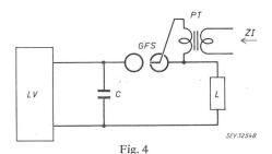
Prinzipielle Schaltung einer gesteuerten Funkenstrecke als Schalter eines kapazitiven Energiespeichers
