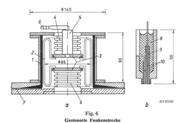
a Aufbau; b Detail der Hilfselektrode
