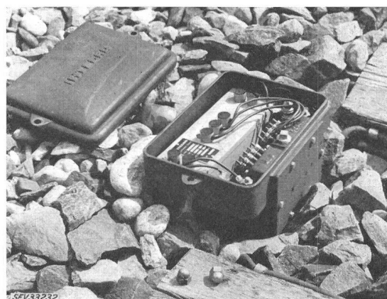
Fig. 10 Anschlusskasten mit Sender und Empfänger für Schienenstromkreis mit 100 kHz
