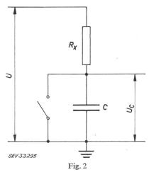
Geänderte Spannungsteilerschaltung unter Ersatz des Normal-Widerstandes  $R_{\scriptscriptstyle N}$  durch einen Kondensator C
