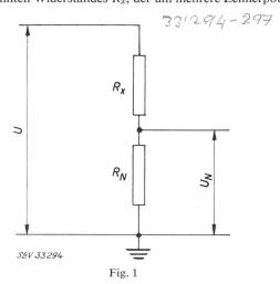
Spannungsteilerschaltung zur Messung hochohmiger Widerstände Bei Verwendung eines hinreichend empfindlichen Gerätes zur Messung von  $U_N$  kann der Widerstand  $R_x$  des Prüflings mehrere Zehnerpotenzen über dem des Normal-Widerstandes  $R_N$  liegen
