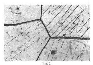
Mikrobereiche der Magnetisierung auf der Oberfläche eines SiFe-Bleches
