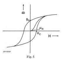
Typische Hystereseschleife eines polykristallinen ferromagnetischen Materials ohne Vorzugslage
