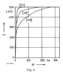
Magnetisierungskurven von Nickeleinkristallen gemessen in verschiedenen kristallographischen Richtungen (nach S. Kaya [10])
