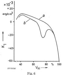
Verlauf der magnetischen Kristallenergie  $K_{\scriptscriptstyle I}$  von NiFe-Legierungen nach Hall [11]  $V_{\scriptscriptstyle N4} \text{ Nickel-Gehalt; } a \text{ abgeschreckte Proben; } b \text{ langsam gekühlte}$  Proben
