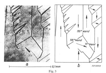
Blochwandstrukturen auf einem Nickelkristall nach W. Stephan aus einer Arbeit von Elschner und Andrä [8] a Originalaufnahme; b schematische Anordnung der Blochwände
