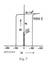
Typische Rechteckschleifen verschiedener Magnetwerkstoffe UZ Legierung mit sehr schmaler Rechteckschleife; 5000 Z wie UZ, aber mit höherer Sättigungsinduktion und höherer Koerzitivfeldstärke B magnetische Induktion; H magnetische Feldstärke
