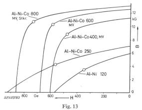
Entmagnetisierungskurven von AlNi- und AlNiCo-Dauermagnetwerkstoffen
