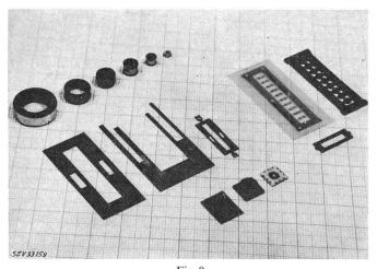
Fig. 9 Anwendungsformen für dünne Bänder Zwergkerne, Folienkernformen, ferner Tranfluxorformen
