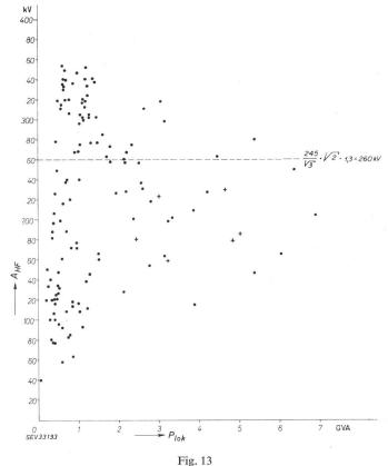
Amplituden der hochfrequenten Transformatorschwingungen  $\hat{A}_{HF}$  (Fälle b) in Funktion der lokal aufgebrachten Leistung  $P_{lok}$  in den schweizerischen Netzpunkten und für die Grundtypen bei 245 kV
