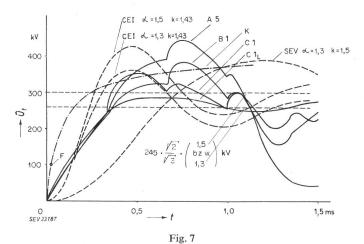
Verlauf der berechneten transitorischen wiederkehrenden Spannung  $\mathcal{O}_t$  bei den 245-kV-Stations-Grundtypen und bei voller Kurzschlussleistung
