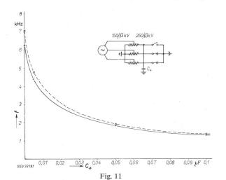
Eigenfrequenz eines Dreiphasen-125-MVA-Autotransformators in Funktion künstlicher Zusatzkapazitäten  $C_+$  (Fall Nr. T 7 der Tabelle II)
