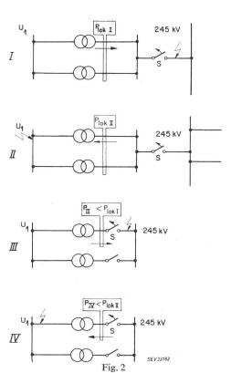
Schemata einiger Transformator-Schaltfälle des Typs b Erklärungen siehe im Text
