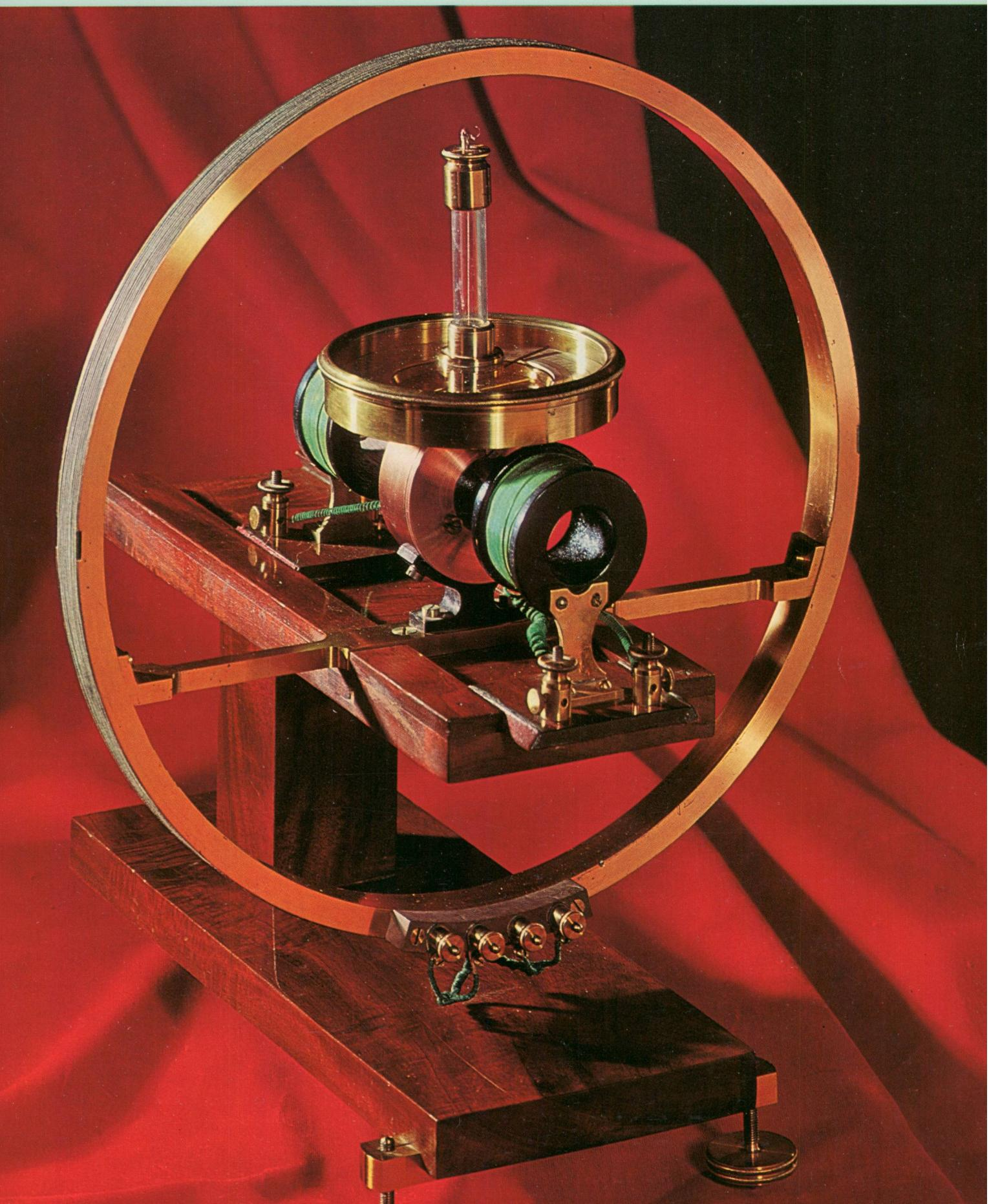
**Titelblatt:** Tangentenbussole aus dem Jahr 1837. Das elektrische Messinstrument diente zur Messung von Gleichströmen. Es ist mit zwei Spulen versehen, die auf eine Magnetnadel wirken. (Aus der Sammlung von *W. Acklin*, Zürich.)
